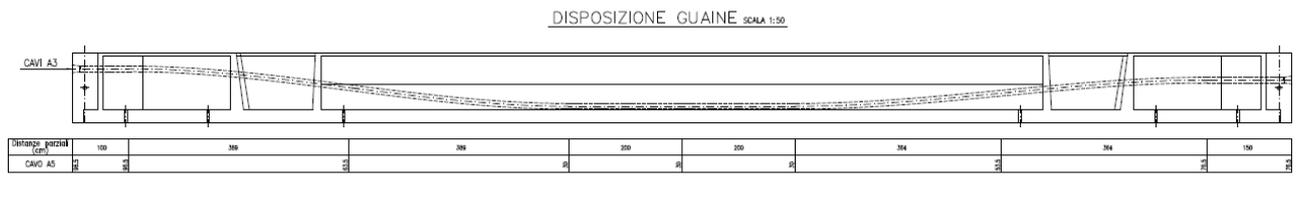
Figura 11. Andamento cavi di precompressione post-tesi nuove travi in c.a.p. in carreggiata di discesa
