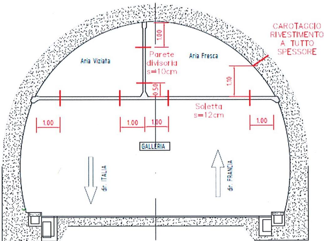
Fig. 1 - Indicazione schematica dei punti di carotaggio, per ogni singola sezione di campionamento
